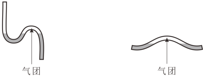
图3 错误的管道连接方法
